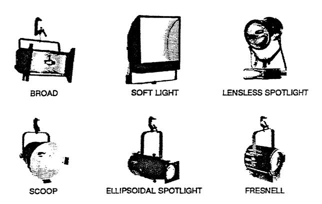
Figure 2-1. ARTIFICIAL LIGHTING INSTRUMENTS
